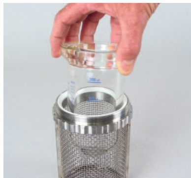
Защитный кожух для стеклянного сосуда (металлическая сетка)
