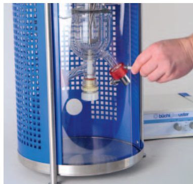
Штатив с защитным прозрачным экраном из поликарбоната
