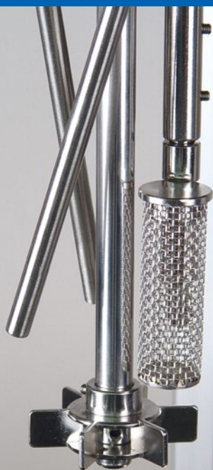
Неподвижная корзинка для катализатора и газозахватывающая турбинная мешалка реактора 1 л / 60 бар
